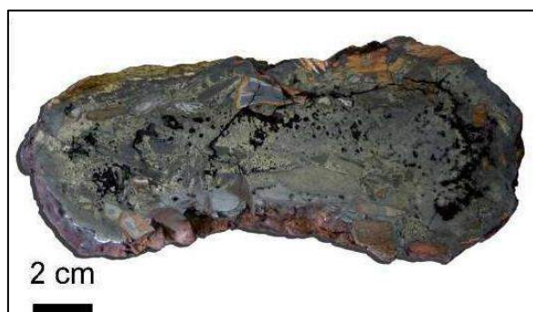
Figure 10 : Echantillon mixte (chaîne métallique fondue et fragments de clinker) du terril de la Ricamarie peut être utilisé comme géothermomètre par la présence d'exsolutions de fer natif qui indique une température d'environ 1300°C ([23] issus de Guy et al. , 2001)
